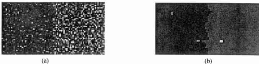
图 3 (a) 为随机产生的两个具有 Gamma 分布的区域,两个区域的视数都为 3,左边的均值为 5,右边的均值为 10; (b) 为采用本文中算法的分割结果
